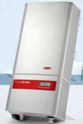
/ Die Wechselrichtergeneration Fronius IG Plus ist die Weiterentwicklung der bewährten Fronius IG-Familie. Leistungsklassen von 2,6 bis 12 kW versprechen die Eignung für jede erdenkliche Anlagengröße. Mit einem maximalen Wirkungsgrad von 95,9 % erzielt die Fronius IG Plus-Serie einen der höchsten Werte bei Trafowechselrichtern.
