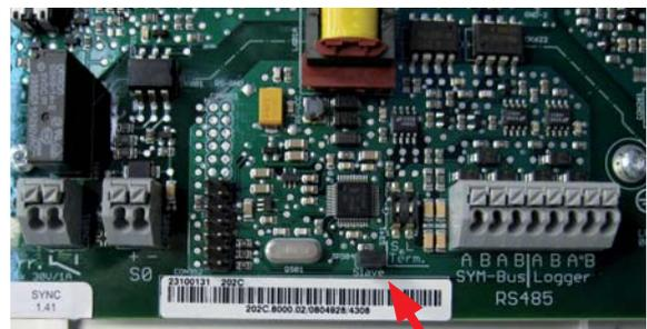
Abbildung 6.9: RS485-Schnittstelle und Slave Jumper
