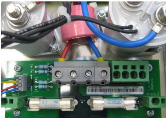
Abbildung 6.6: Anschlussklemme für externen Strangsammler
