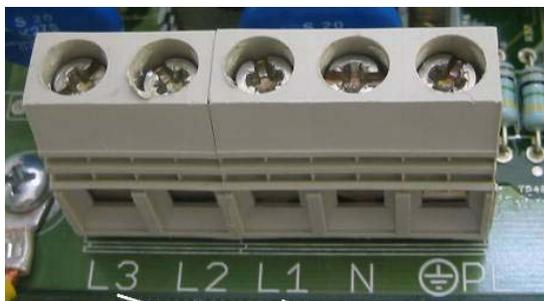
Abbildung 9.4: **AC-Anschlussklemme**
