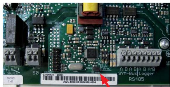
Abbildung 4.8: **RS485-Schnittstelle und Slave Jumper**
