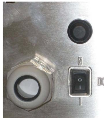
Abbildung 6.7: Kippschalter an der Geräteunterseite
